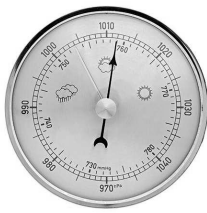
Atmosfer basıncını ölçen alet
